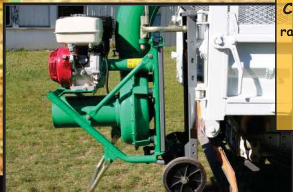
Centrale d'aspiration orientable de 30° à gauche et à droite
