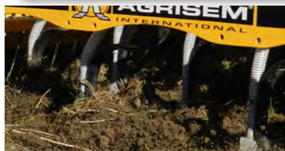
Les dents vibrantes affinent la terre avant le placement de la graine dans un lit de semence homogène.
