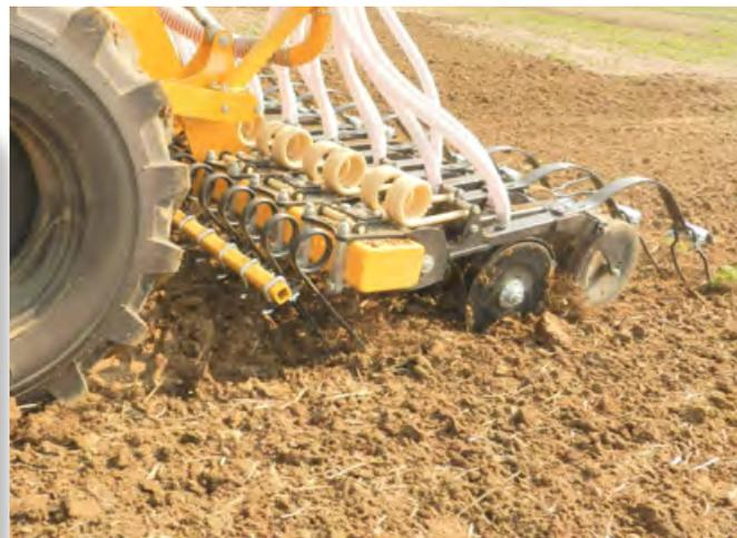
En un seul passage, cette machine travaille le sol, rappuie et sème en ligne. Elle permet la fertilisation du sol à l'avant puis dépose ensuite la graine par la rampe de semis.
