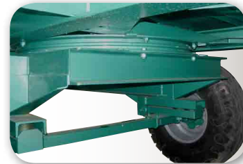
Plaque tournante : Tourelle style routière sur roulement à billes avec graisseur
